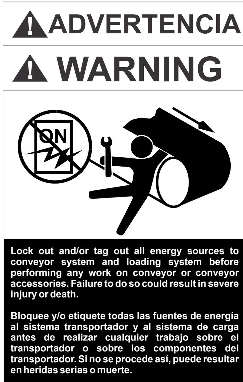
Figura 8. Etiqueta de Advertencia de Productos del Transportador, N/P 23395
